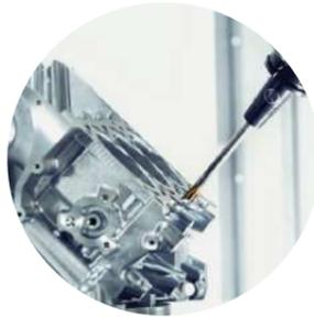
Il portautensile ad espansione idraulica TENDO Slim 4ax combina la geometria dei portautensili a caldo conformi alla normativa DIN 69882-8 con la qualità comprovata dell'espansione idraulica. L'attacco slim particolarmente preciso, concepito appositamente per le lavorazioni assiali, mostra tutte le sue potenzialità durante la fresatura vicina ai bordi del pezzo, la lamatura, l'alesatura e la filettatura nei centri di lavoro a 5 assi, nella costruzione di prototipi e degli stampi.
