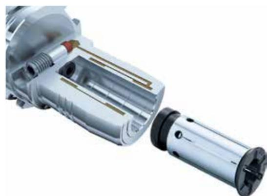
Le bussole di riduzione SCHUNK consentono il bloccaggio di diversi diametri di gambo con un solo portautensile. Le bussole di riduzione universali GZB-S sono disponibili in due versioni: a tenuta di refrigerante e a refrigerazione periferica. Entrambe possono essere utilizzate nei portautensili SCHUNK TENDO, TRIBOS e SINO-R e in tutti i portautensili idraulici standard presenti sul mercato.
